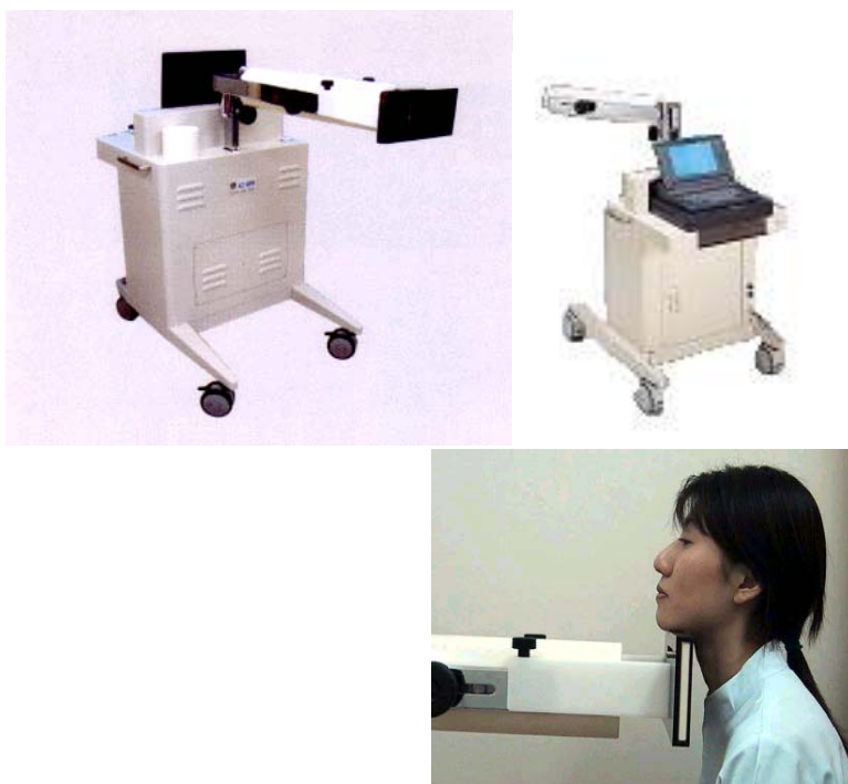
図3. 甲状腺摂取率測定装置および測定の様子
