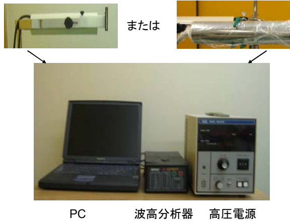
図 4c. NaI(Tl) 検出器に接続する装置
