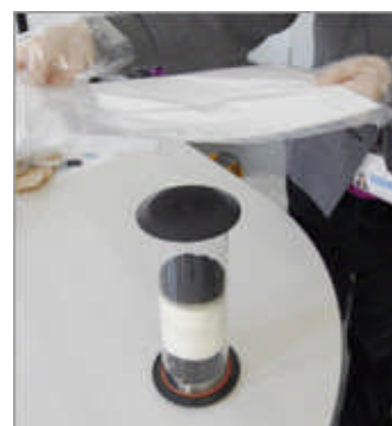
石英繊維フィルター（上）と活性炭素 繊維フィルター（下の円筒中の黒い部分）
