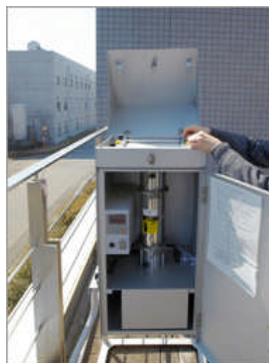
国立環境研究所敷地内に設置された ハイボリュームエアサンプラ
